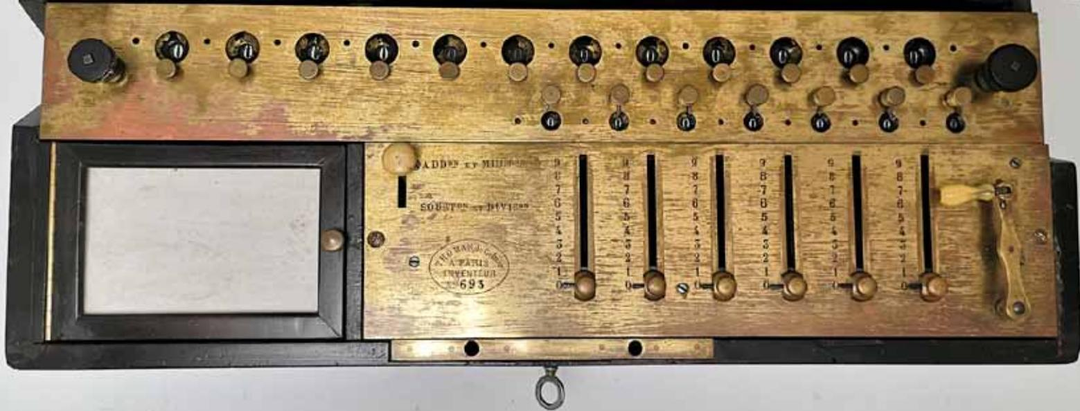
Modèle perfectionné pouvant exécuter les 4 opérations (avec index à deux positions). Machine à calculer à 6 scripteurs ; totalisateur de 12 chiffres et compte-tours de 7 chiffres. Type T1865 A (voir site [arithmometre.org](http://arithmometre.org)).
