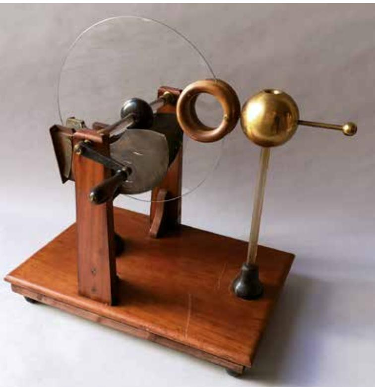
Une manivelle permet d'actionner les deux hélices métalliques placées de chaque côté du disque en verre qui, par frottement, charge l'électricité ; des peignes circulaires (collecteurs de charge) sont logés dans deux anneaux de bois et transfèrent ces charges à un conducteur isolé (sphère en lai-
