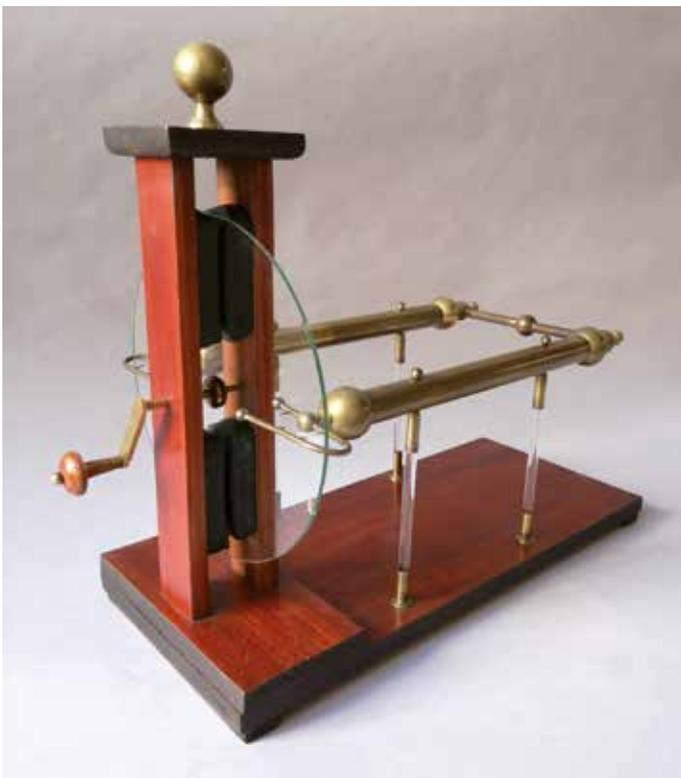
tourner à l'aide d'une manivelle. Ce plateau, pressé entre quatre coussins de cuir, passe entre deux tubes de laiton courbes en forme de fer à cheval et armés de chaque côté de dents, que l'on appelle les peignes. Ceux-ci sont fixés sur deux gros tubes de laiton horizontaux, constituant les conducteurs, isolés par des pieds en verre. Les conducteurs sont reliés entre eux par un tube latéral, par où sera recueillie l'électricité.
